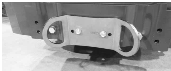
Suporte de conexão A418623 instalado no para-choques traseiro ou no contrapeso
