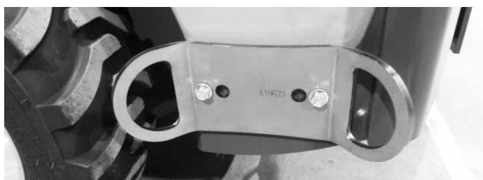
Suporte de conexão A418623 instalado na lateral da estrutura traseira. São necessários dois suportes para instalação lateral.
